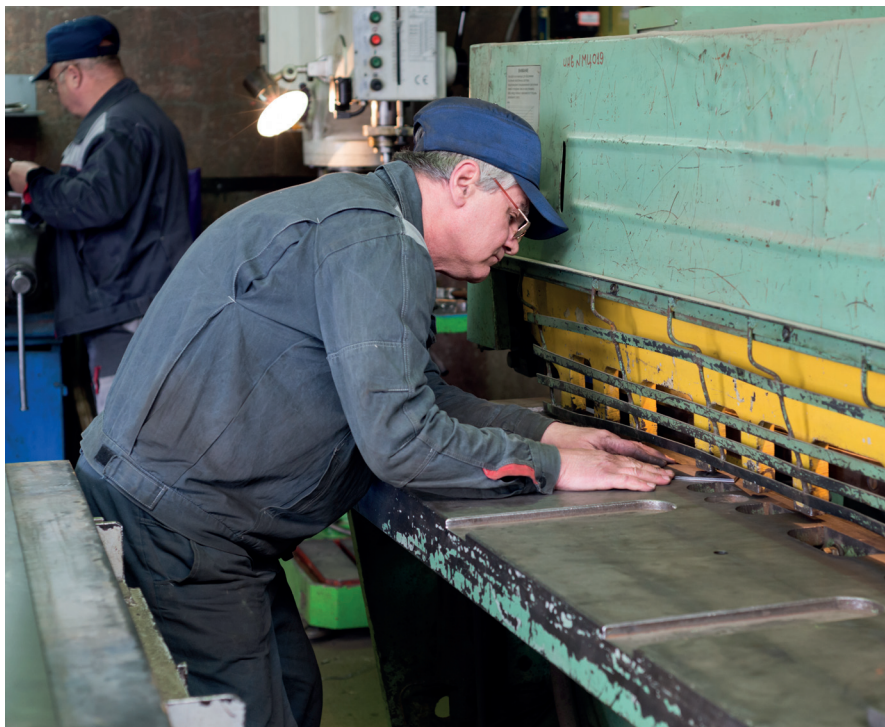
Rysunek 7. Cięcie blachy gilotyną przemysłową
